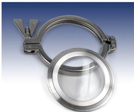
Una mirilla fabricada con polímeros de grado óptico insertada en un anillo de acero inoxidable. Se instala a través de una abrazadera sanitaria que agiliza el desmontaje durante la limpieza. Las mirillas sanitarias MetaPlex® ofrecen mayor resistencia y mejor desempeño a temperaturas elevadas. Ideal para aplicaciones químicas, farmacéuticas, de alimentos y bebidas, y fabricación de cerveza.
