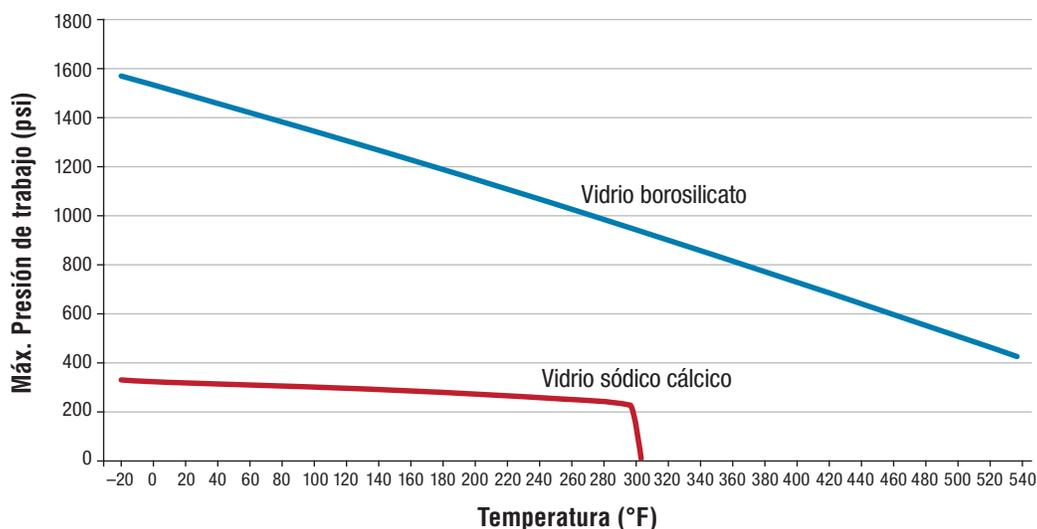
Este gráfico muestra la temperatura de funcionamiento de una mirilla de borosilicato fundida y una mirilla sódica cálcica fundida a diferentes temperaturas. (De "Compression vs. Fusion in Sight Glass Construction" de Karl Schuller, Herberts Industrieglas GmbH. Utilizado con permiso).
